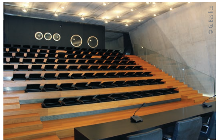
Blick in das Auditorium, das 108 Besucher fasst. Die Steuerung des Raumes erfolgt über einen Busklemmen-Controller. In der Software voreingestellte Lichtszenarien für verschiedene Anlässe sind einfach abrufbar.
