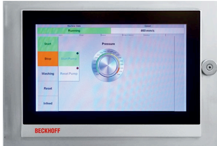
Als HMI-Interface ist ein Control Panel CP2911 im Einsatz.
