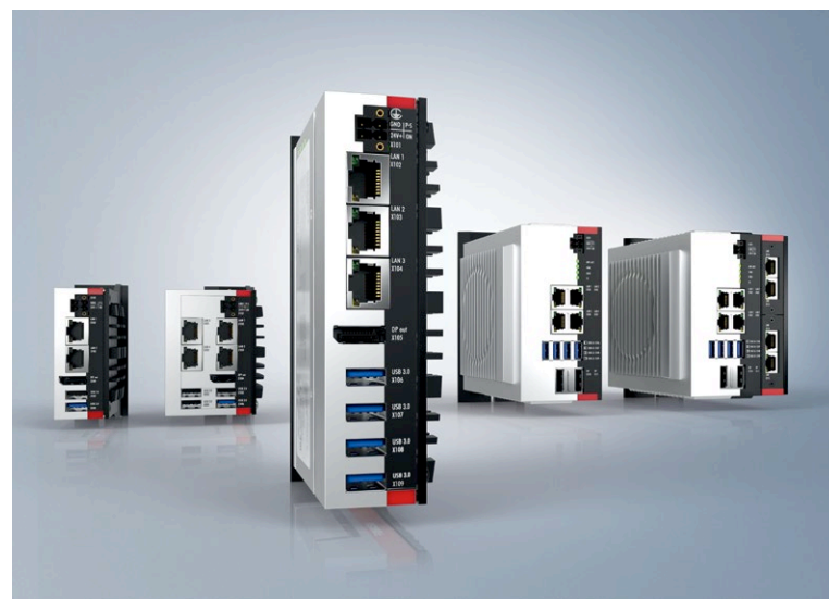
Innerhalb der modernen und flexibel montierbaren Ultra-Kompakt-Industrie-PC-Serie C60xx stehen inklusive des neuen lüfterlosen Intel®-Core™-i-Rechners C6025 (Mitte) nun zusätzlich drei neue Intel®-Prozessorgenerationen zur Verfügung.
