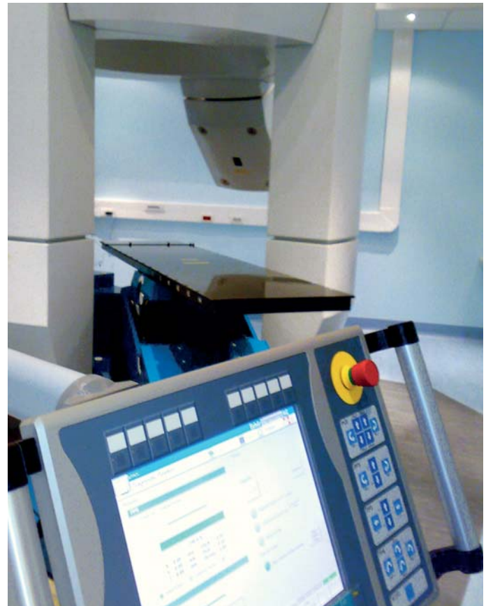
Beckhoff Control Panel CP7911 mit Notaus-Taster und kundenspezifischem Tastenfeld
