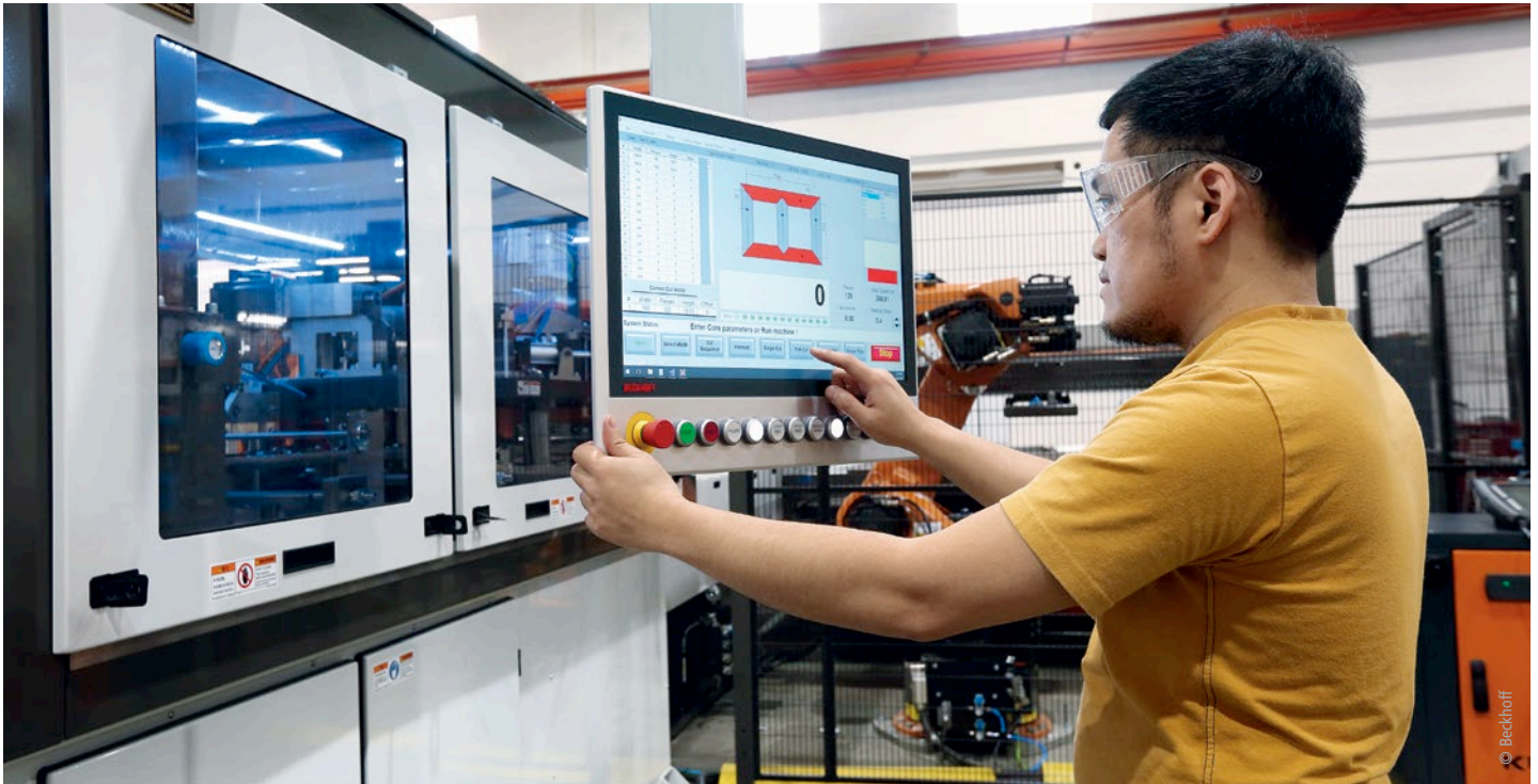
Ein 21,5-Zoll-Multitouch-Control-Panel CP3921 dient als Bedienerchnittstelle an der Schneidzelle; ein 12-Zoll-Multitouch-Control-Panel CP2912 befindet sich an der Stapelzelle.
