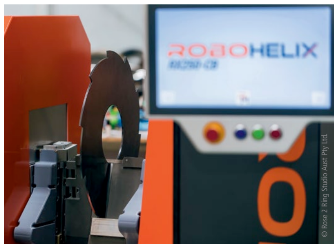
Die RoboHelix-Maschinen formen Schneckenwendeln aus runden oder gezahnten Rohlingen, den sogenannten Ronden.
