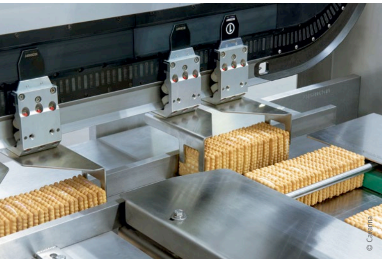
Die Keks-Slugs werden vor der Aufnahme durch die XTS-Mover um 90° gekippt.
