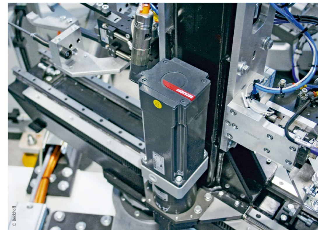
Das dezentrale Anschlusskonzept auf Basis von EtherCAT P und die kompakten Servoantriebe AMP8000 sparen wertvollen Platz in der Maschine.
