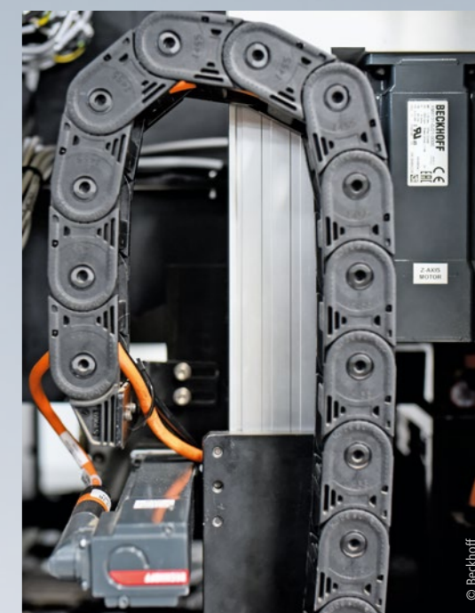
Servomotoren AM81xx bewegen die fünf Servoachsen für Drehen und Positionieren der Smart Devices und vereinfachen durch die One Cable Technology (OCT) die Installation und Inbetriebnahme.
