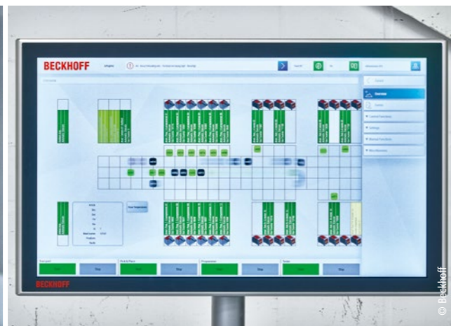
Die Positionen der 33, über insgesamt 100 XPlanar-Kacheln schwebenden Mover werden in Echtzeit in der mit TwinCAT HMI projektierten Visualisierung angezeigt.
