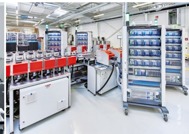
Wie die gesamte Anlagentechnik sind auch die fahrbaren Prüfschränke komplett mit Komponenten aus dem Beckhoff-Portfolio aufgebaut.
