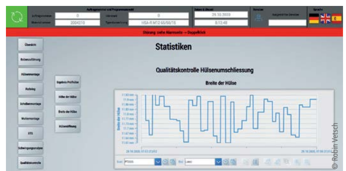
Darstellung der Hülsenbreite als eines der Qualitätskriterien bei der Hülsenumschließung
