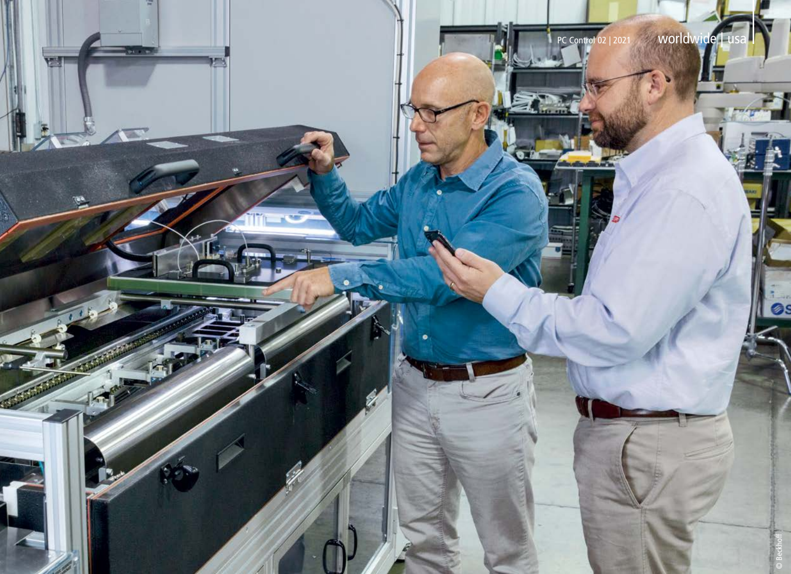
Oben: Im POV-Werk inspizieren Dan Distefano (links), Senior Software Engineer und Inhaber von D2 Engineering, und Casey Taylor, Regional Sales Engineer von Beckhoff, den neuen Leiterplatten-Testhandler.
