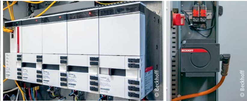
Oben: Das Multiachs-Servosystem AX8000 stellt eine dynamische und präzise Bewegungssteuerung sicher.
