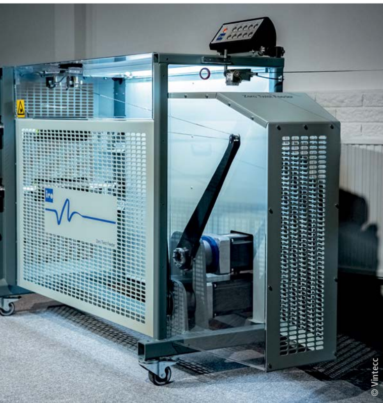
Der Zero Twist Feeder liefert mit hoher Präzision das für den Webprozess notwendige Garn.
