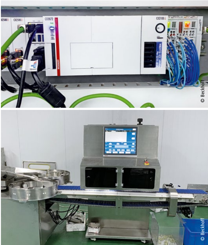
Oben: Ein leistungsfähiger Embedded-PC CX2072 dient als All-in-One-Steuerungsplattform für die von Xin Hang Cheng entwickelte Highspeed-Weichkapsel-Inspektionsmaschine.
