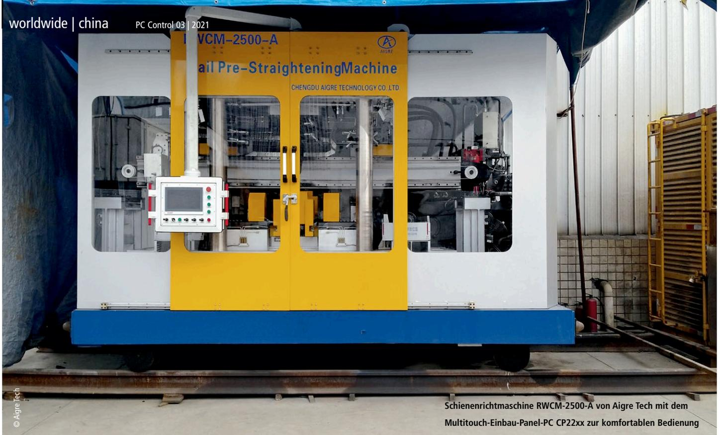
Schienenrichtmaschine RWCM-2500-A von Aigre Tech mit dem Multitouch-Einbau-Panel-PC CP22xx zur komfortablen Bedienung
