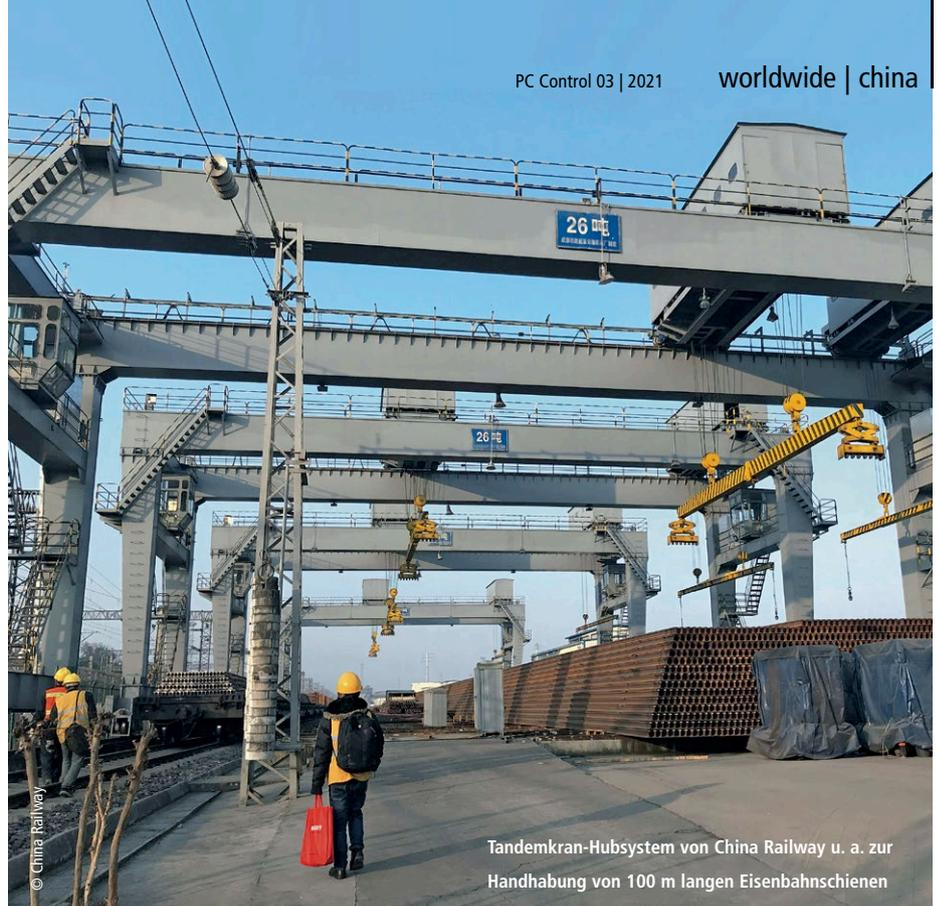
Tandemkran-Hubsystem von China Railway u. a. zur Handhabung von 100 m langen Eisenbahnschienen
