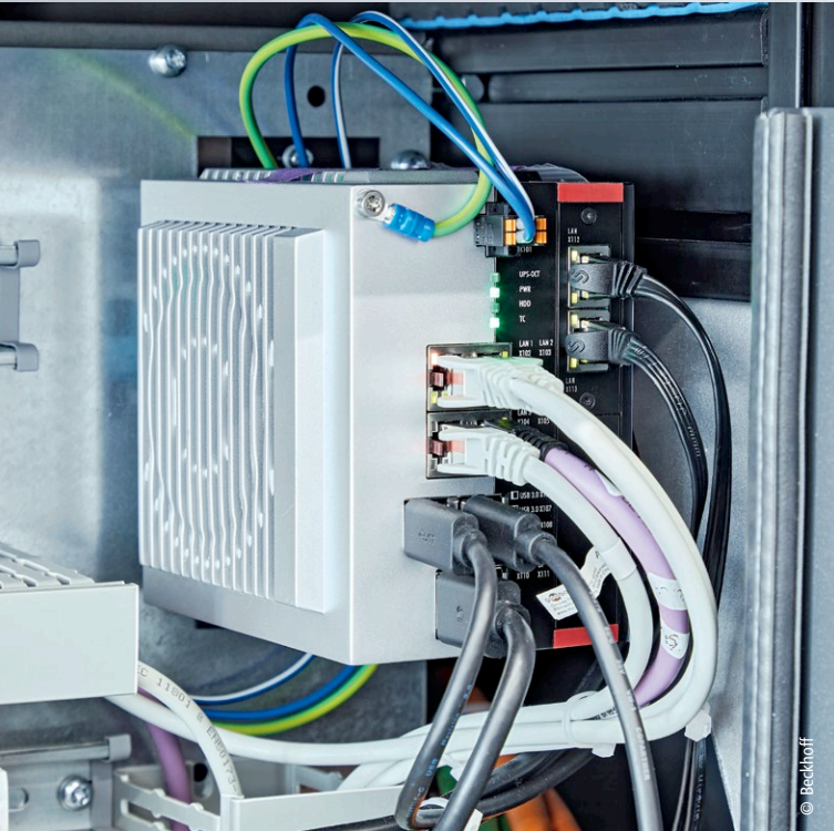
Der leistungsfähige Ultra-Kompakt-Industrie-PC C6032 steuert mit zahlreichen TwinCAT-Funktionen, wie z. B. TwinCAT Vision, alle Maschinen- und Prozessabläufe.
